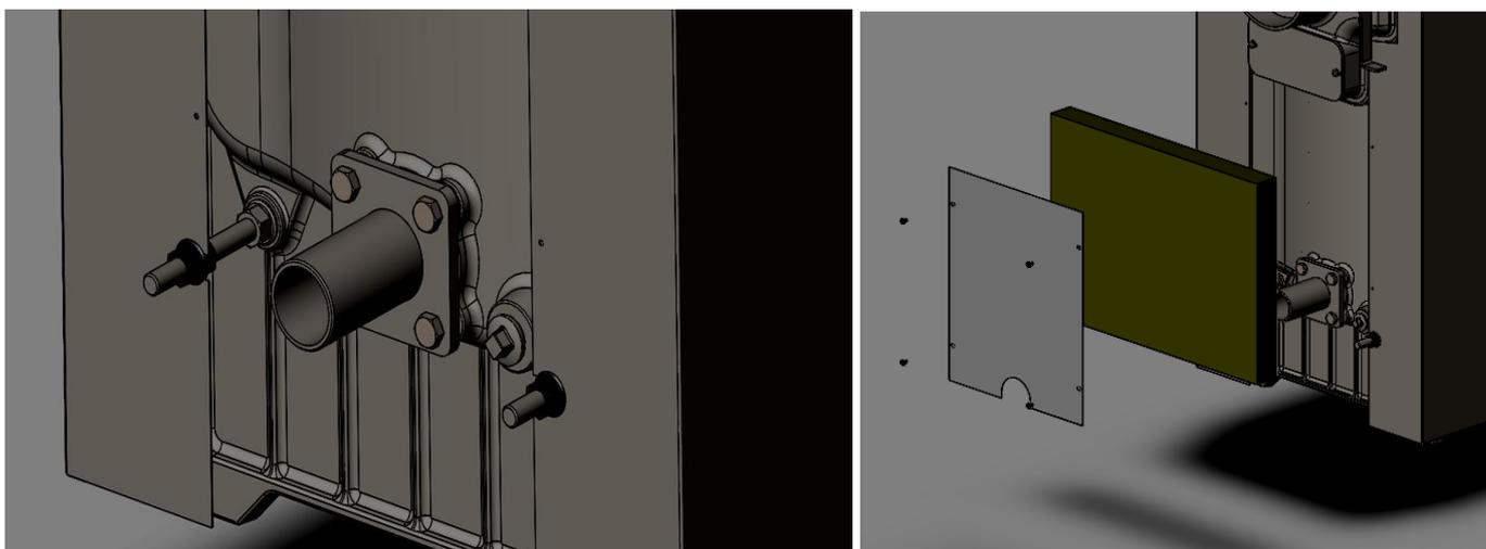
6. Установите переднюю панель на боковые панели, закрепив ее четырьмя винтами М8. Вставьте термометр, входящий в комплект принадлежностей, в круглое отверстие на верхней панели, прикрепите его датчик к переднему карману, как показано ниже. Затем закрепите верхнюю панель четырьмя саморезами 4,2x9,5.
