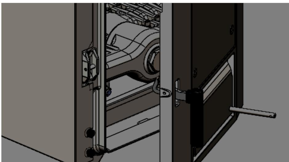
4. Поместите изоляцию корпуса котла непосредственно на корпус котла. Затем зафиксируйте боковую и левую панели. Используйте четыре винта M10x16 на передней части котла вместе с шайбами M10 с левой стороны. Просто затяните имеющиеся гайки на правой боковой панели. Сначала установите одну гайку M12 на заднюю часть котла, затем закрепите четыре части шайб M12 и гаек M12 в каждом углу после установки заднего изгиба боковых панелей.
